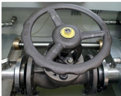
Компания **Клингер Флуид Контрол ГмбХ** постоянно прилагает усилия к совершенствованию своей продукции. Мы увеличили срок службы наших вентиляей с помощью технологии, пришедшей из автомобильной промышленности и успешно опробованной для колец шаровых кранов КНА и КНЕ . Шпиндель поршневых вентиляей покрывается специальным лаком с уникальными трибологическими свойствами. Это наш новый стандарт
