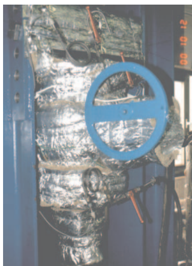
Шаровой кран «Баллостар» испытание по EN 488
