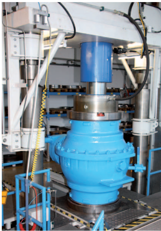
Испытание давлением шарового крана «Баллостар» KHSVI по EN12266 P10, P11, P12
