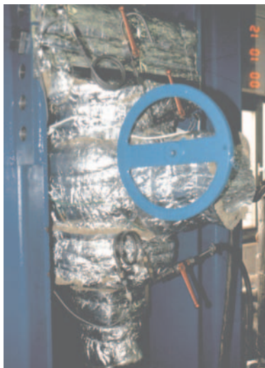
Шаровой кран «Баллостар» испытание по EN 488
