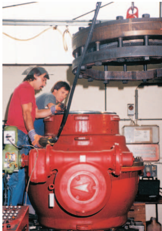
Испытание давлением шарового крана «Баллостар» KHSVI по DIN 3230
