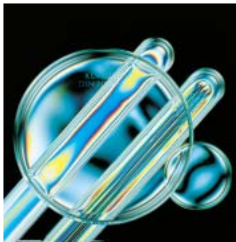
Термически преднапряженные круглые и длинные смотровые стекла в поляризованном свете
